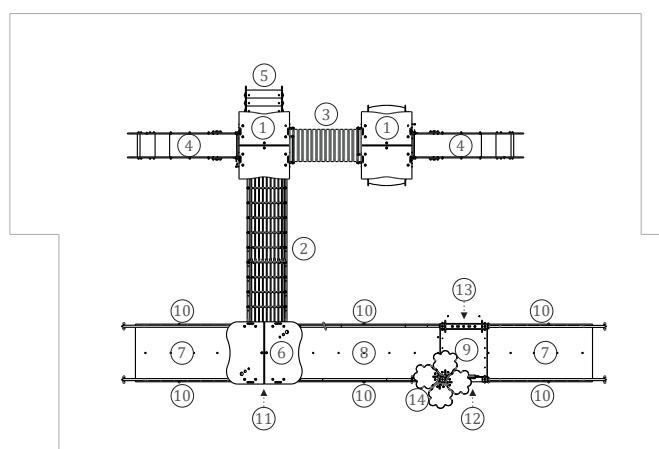
Utilização do equipamento sujeito a condições vigiadas; Zona de segurança: Área mínima requerida pela norma EN 1176-1,6
