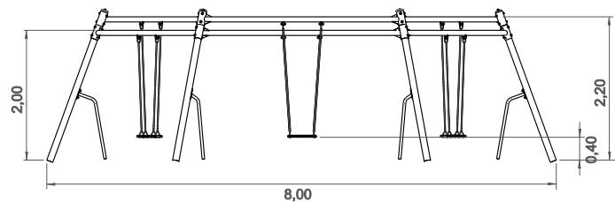
Utilização do equipamento sujeito a condições vigiadas; Zona de segurança: Área mínima requerida pela norma EN 1176-1,6
