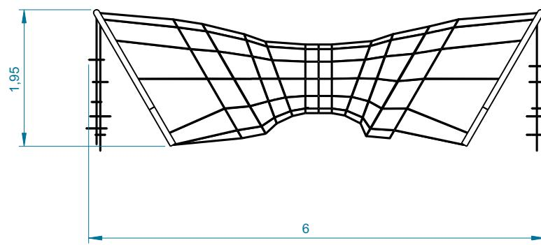
Utilização do equipamento sujeito a condições vigiadas; Zona de segurança: Área mínima requerida pela norma EN 1176-1,6
