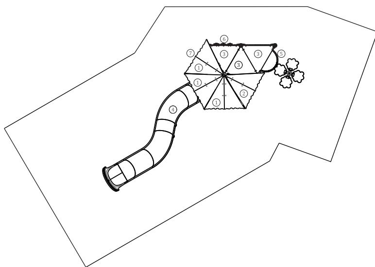
Utilização do equipamento sujeito a condições vigiadas; Zona de segurança: Área mínima requerida pela norma EN 1176-1,6
