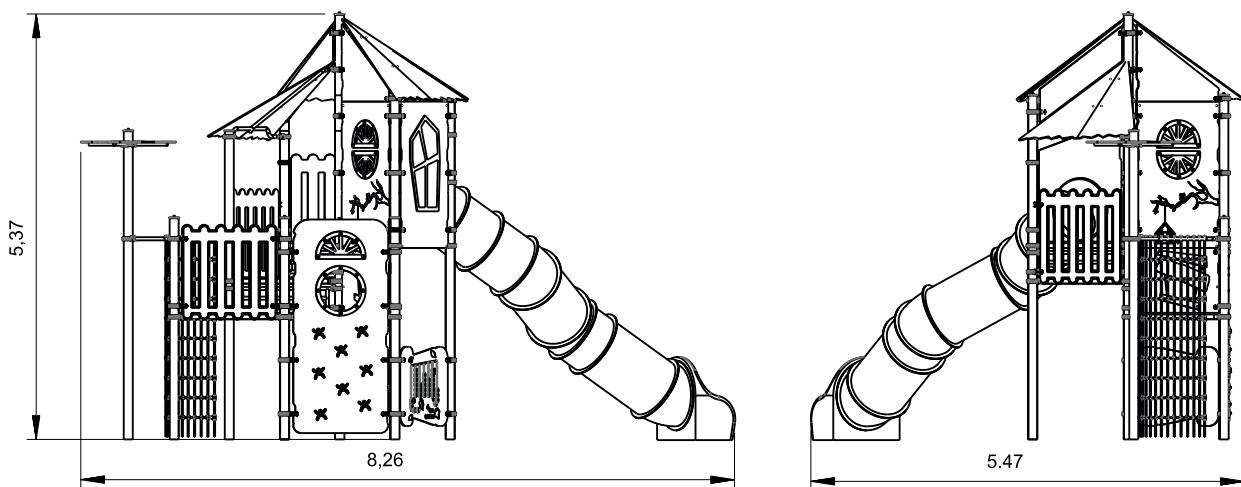
Utilização do equipamento sujeito a condições vigiadas; Zona de segurança: Área mínima requerida pela norma EN 1176-1,6
